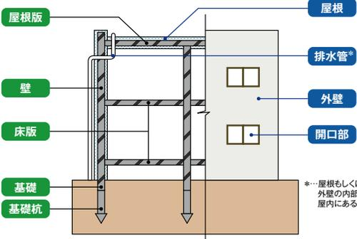
雨水の浸入を防止する部分
