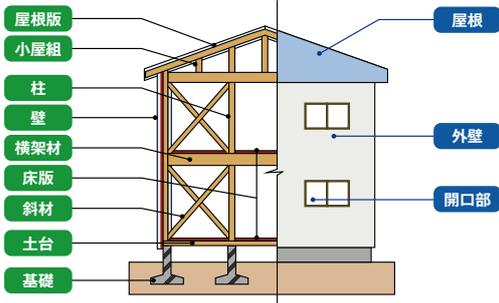
雨水の浸入を防止する部分
